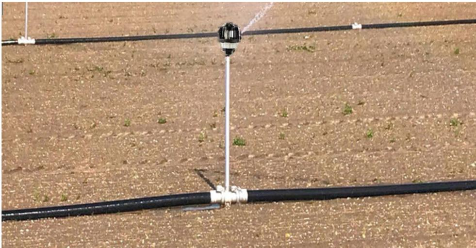
Acople Te M-H (DN50-DN63) en aluminio o en PE
